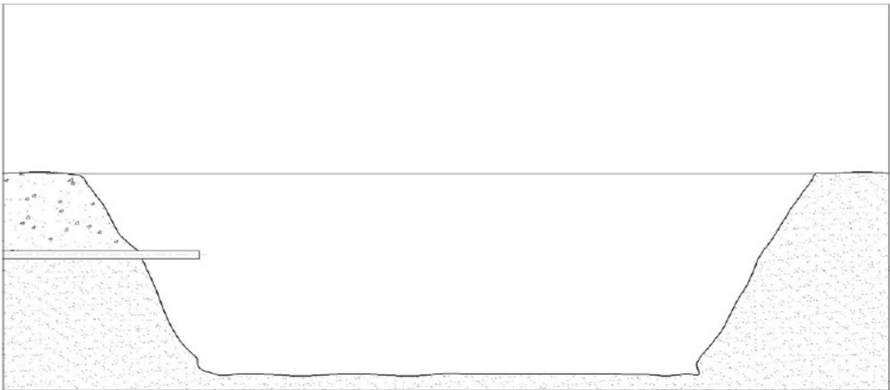
2) Основание котлована должно быть ровным и строго горизонтальным. При возможных перекопах основания котлована производить подсыпку песком с уплотнением водой. Дно котлована должно быть тщательно утрамбовано ручными трамбовками, пневмотрамбовками или поливом водой.
